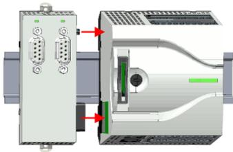
4. ➔ Binden Sie das Erweiterungsmodul an die CPU an, indem Sie das Erweiterungsmodul auf der Tragschiene nach rechts schieben, bis der Schnittstellen-Anschluss in der CPU leicht einrastet.
