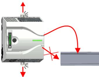
3. ➔ Ziehen Sie die Entriegelungshebel der CPU soweit nach außen, bis diese hörbar einrasten.
