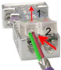
1. ➤ Lösen Sie die Schraube.
