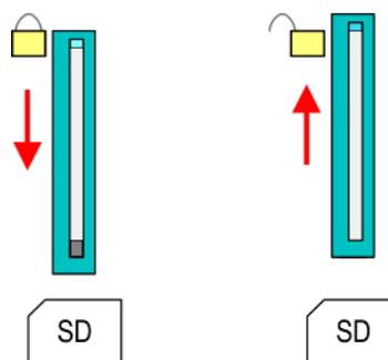
Zum Entnehmen schieben Sie die Schiebemechanik wieder nach oben und drücken Sie die VSD gegen den Federdruck nach innen, bis diese mit einem Klick entriegelt wird.
