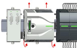
3. ➔ Nehmen Sie die CPU mit einer Drehung nach oben von der Tragschiene ab.
