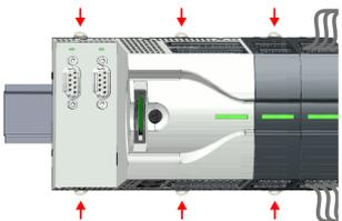
7. ➔ Schieben Sie die Verriegelungshebel wieder zurück in die Ausgangsposition.
