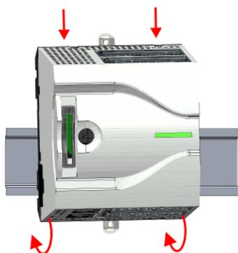
4. ➔ Stecken Sie die CPU von oben auf die Tragschiene und drehen Sie die CPU nach unten, bis diese auf der Tragschiene aufliegt.
