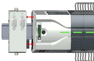
8. ➤ Binden Sie das Erweiterungsmodul wieder an die CPU an, indem Sie das Erweiterungsmodul auf der Tragschiene nach rechts schieben, bis der Schnittstellen-Anschluss in der CPU leicht einrastet.
