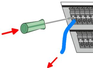
Das Entfernen eines Drahtes erfolgt mittels eines Schraubendrehers mit 2,5mm Klingbreite.
