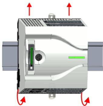
2. ➔ Nehmen Sie die CPU mit einer Drehung nach oben von der Tragschiene ab.
