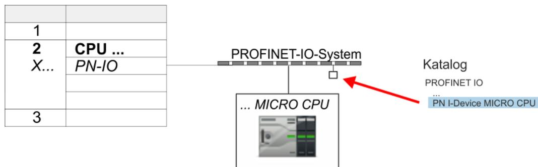
2. ➔ Öffnen Sie den Eigenschaften-Dialog des PROFINET-IO-Controllers der CPU, indem Sie auf "*PN-IO*" doppelklicken und vergeben Sie hier den Namen für das I-Device.
