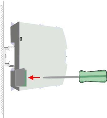
2. ➔ Das Erweiterungsmodul besitzt an der Ober- und Unterseite einen Verriegelungshebel. Ziehen Sie diese Hebel wie in der Abbildung gezeigt soweit nach außen, bis diese hörbar einrasten.
