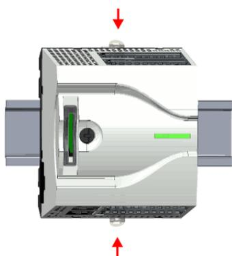
6. ➔ Schieben Sie zur Fixierung der CPU auf der Tragschiene die Verriegelungshebel wieder zurück in die Ausgangsposition.
