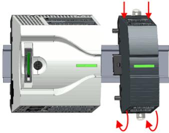
3. ➔ Zur Montage stecken Sie das Peripheriemodul von oben auf die Tragschiene und drehen Sie das Peripheriemodul nach unten, bis dieses auf der Tragschiene aufliegt.
