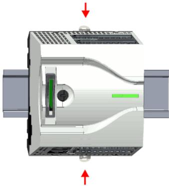
5. ➔ Schieben Sie zur Fixierung der CPU auf der Tragschiene die Verriegelungshebel wieder zurück in die Ausgangsposition.
