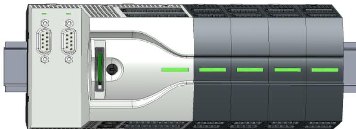
Das System MICRO ist ein modular aufgebautes Automatisierungssystem für die Montage auf einer 35mm Tragschiene. Mittels Peripheriemodule können Sie dieses System an Ihre Automatisierungsaufgaben adaptieren. Zusätzlich besteht die Möglichkeit Ihre CPU um entsprechende Schnittstellen zu erweitern. Der Verdrahtungsaufwand ist gering gehalten, da die DC 24V Elektronikversorgung im Rückwandbus integriert ist und einen Austausch bei stehender Verdrahtung ermöglicht.
