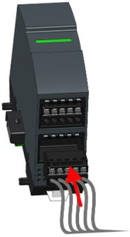
9. → Stecken Sie wieder die verdrahteten Steckverbinder.
