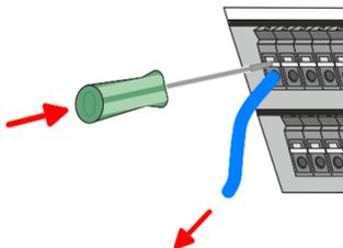
Das Entfernen eines Drahtes erfolgt mittels eines Schraubendrehers mit 2,5mm Klingbreite.
