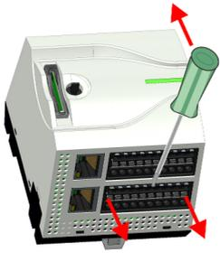
7. ➔ Entfernen Sie die überflüssigen Steckverbinder an der CPU.
