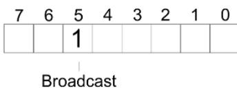
Eine Anforderung kann an einen bestimmten Slave gerichtet sein oder als Broadcast-Nachricht an alle Slaves gehen. Zur Kennzeichnung einer Broadcast-Nachricht ist Bit 5 im ADR-Byte auf 1 zu setzen. Hierbei wird die Slave-Adr. (Bit 0 ... 4) ignoriert. Im Gegensatz zu einem "normalen" Send-Auftrag ist beim Broadcast keine Telegrammauswertung über FC/SFC 218 SER\_RCV erforderlich. Nur Schreibaufträge dürfen als Broadcast gesendet werden.
