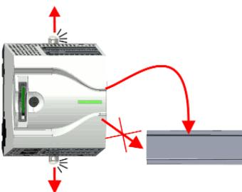
4. ➔ Ziehen Sie die Entriegelungshebel der CPU soweit nach außen, bis diese hörbar einrasten.
