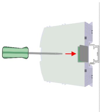
1. ➔ Entfernen Sie auf der rechten Seite der CPU die Bus-Abdeckung mit einem Schraubendreher.
