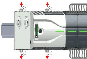
1. ➔ Sofern ein Erweiterungsmodul an die CPU angebunden ist, müssen Sie dieses von der CPU abziehen. Ziehen Sie hierzu mittels eines Schraubendrehers die Entriegelungshebel von Erweiterungsmodul und CPU soweit nach außen, bis diese hörbar einrasten.
