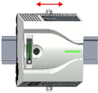
4. ➔ Verschieben Sie die CPU auf der Tragschiene an die gewünschte Position.
