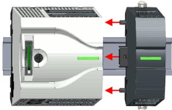
4. ➔ Binden Sie das Peripheriemodul an die CPU an, indem Sie das Peripheriemodul auf der Tragschiene nach links schieben, bis der Schnittstellen-Anschluss in der CPU leicht einrastet.
