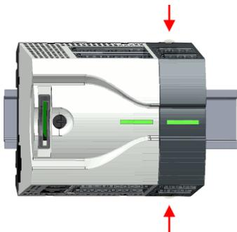
5. ➔ Schieben Sie zur Fixierung des Peripheriemoduls auf der Tragschiene die Verriegelungshebel wieder zurück in die Ausgangsposition.
