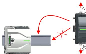
2. ➔ Das Peripheriemodul besitzt an der Ober- und Unterseite einen Verriegelungshebel. Ziehen Sie diese Hebel wie in der Abbildung gezeigt soweit nach außen, bis diese hörbar einrasten.
