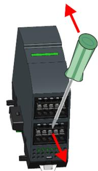
8. ➔ Entfernen Sie die überflüssigen Steckverbinder.
