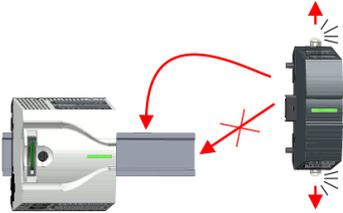
4. ➔ Ziehen Sie die Entriegelungshebel des Peripheriemoduls soweit nach außen, bis diese hörbar einrasten.
