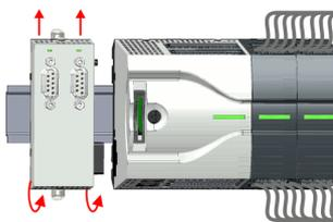
5. ➤ Nehmen Sie das Erweiterungsmodul mit einer Drehung nach oben von der Tragschiene ab.
