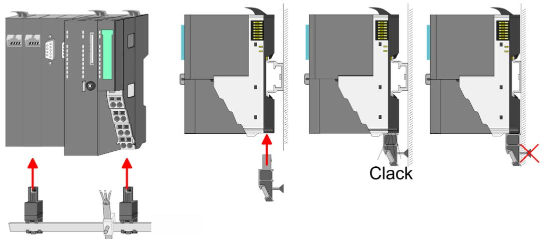
3. Legen Sie ihre Kabel mit dem entsprechend abisolierten Kabelschirm auf und verbinden Sie diese über die Schirmanschlussklemme mit der Schirmschiene.
