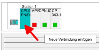
1. Zur Projektierung von Verbindungen blenden Sie die Verbindungsliste ein, indem Sie die entsprechende CPU auswählen. Rufen Sie über das Kontext-Menü *Neue Verbindung einfügen* auf:
