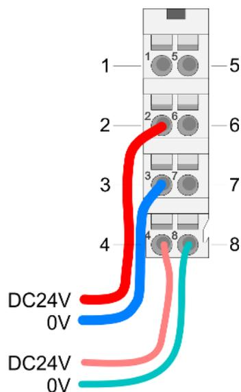
Für Drähte mit einem Querschnitt von 0,08mm<sup>2</sup> bis 1,5mm<sup>2</sup>.
