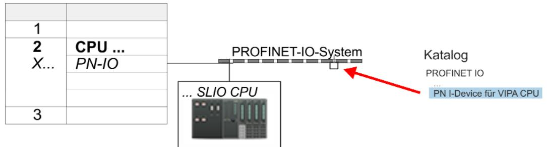
2. Öffnen Sie den Eigenschaften-Dialog des PROFINET-IO-Controllers der CPU, indem Sie auf "PN-IO" doppelklicken und vergeben Sie hier den Namen für das I-Device.
