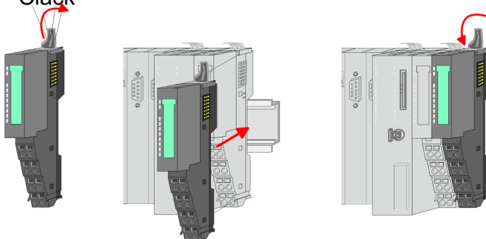
2. Montieren Sie die gewünschten Peripherie-Module.
