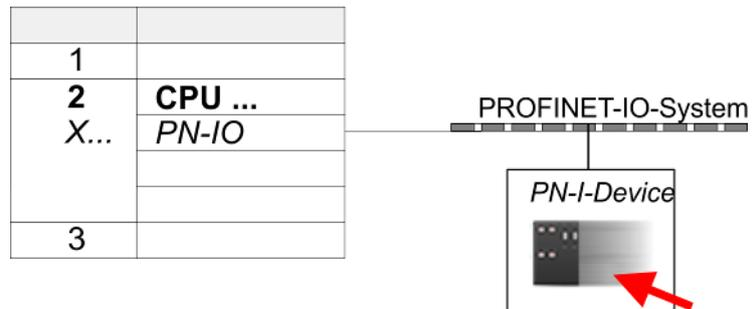
4. ➔ Legen Sie für jeden Ausgangsbereich des I-Device im IO-Controller einen Eingangsbereich gleicher Größe an und umgekehrt. Auch hierbei dürfen sich keine Lücken in der Steckplatzbelegung ergeben. Achten Sie insbesondere darauf, dass die Reihenfolge der Transferbereiche zu denen der I-Device-Projektierung passt. Die folgenden Transfereinheiten stehen zur Verfügung:
