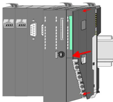
1. Entfernen Sie vor der Montage der Peripherie-Module die Bus-Blende auf der rechten Seite der CPU, indem Sie diese nach vorn abziehen. Bewahren Sie die Blende für spätere Montage auf.
