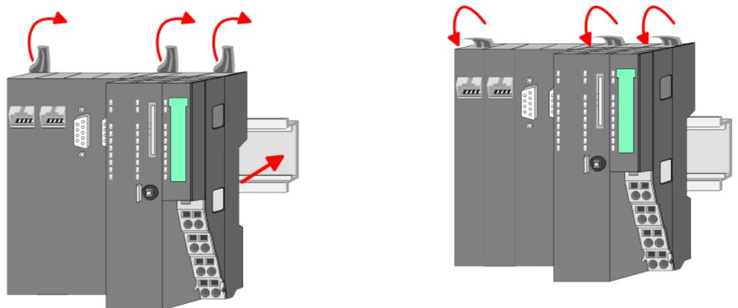
2. Klappen Sie die Verriegelungshebel der CPU nach oben, stecken Sie die CPU auf die Tragschiene und klappen Sie die Verriegelungshebel wieder nach unten.
