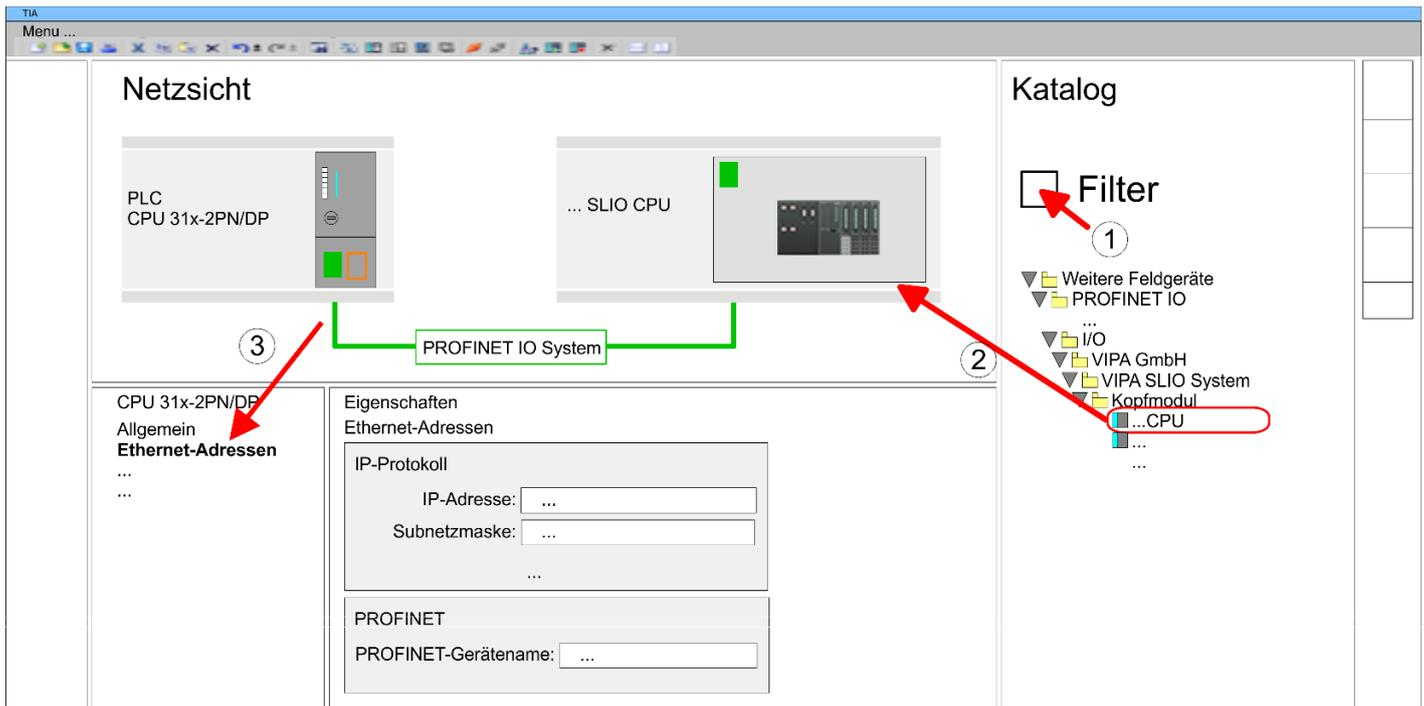
5. ➤ Wählen Sie in der *Netzansicht* das IO-Device "VIPA SLIO CPU..." an und wechseln Sie in die *Geräteübersicht*.
