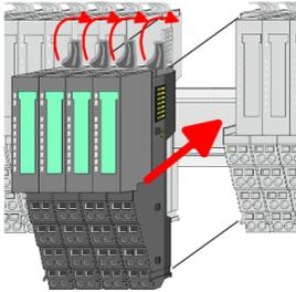
7. ➤ Stecken Sie die zu montierende Modulgruppe in die Lücke zwischen die beiden Module und schieben Sie die Modulgruppe, geführt durch die Führungsleisten auf beiden Seiten, auf die Tragschiene.
