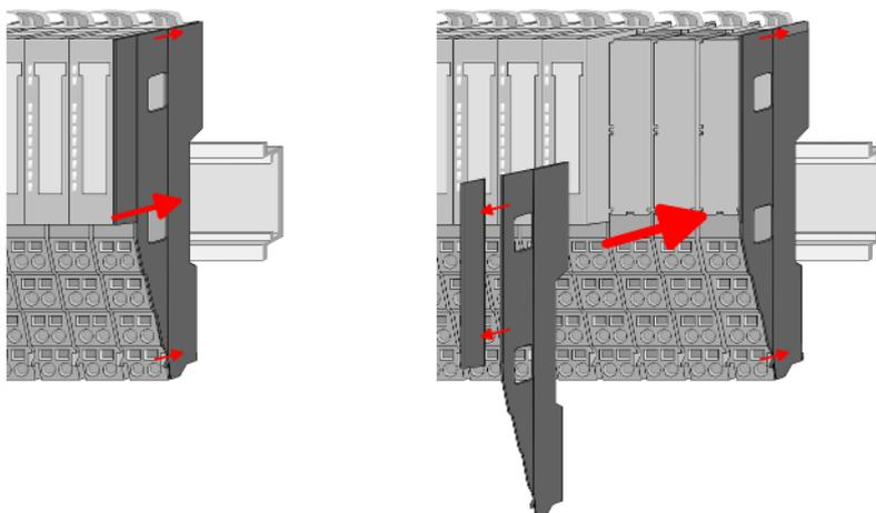
3. Nachdem Sie Ihr Gesamt-System montiert haben, müssen Sie zum Schutz der Bus-Kontakte die Bus-Blende am äußersten Modul wieder stecken. Handelt es sich bei dem äußersten Modul um ein Klemmen-Modul, so ist zur Adaption der obere Teil der Bus-Blende abbrechen.
