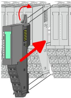
7. ➤ Stecken Sie das zu montierende Modul in die Lücke zwischen die beiden Module und schieben Sie das Modul, geführt durch die Führungsleisten auf beiden Seiten, auf die Tragschiene.
