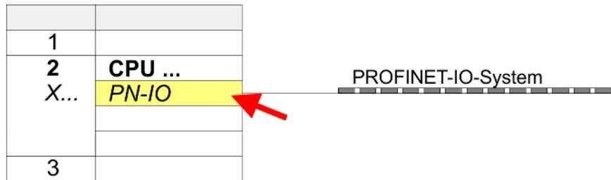
Mit PN-IO parametrieren Sie die PROFINET-Schnittstelle des PROFINET-IO-Controllers und mit Port 1 den Port. Nachfolgend sind die Parameter für PN-IO und Port 1 beschrieben.
