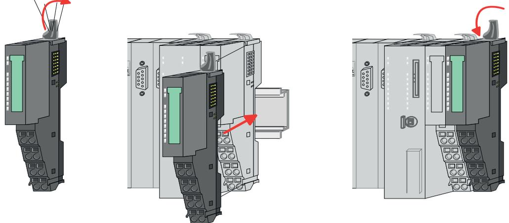
2. Montieren Sie die gewünschten Peripherie-Module.
