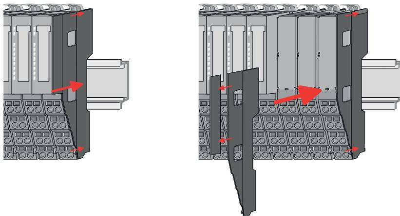
3. ➔ Nachdem Sie Ihr Gesamt-System montiert haben, müssen Sie zum Schutz der Bus-Kontakte die Bus-Blende am äußersten Modul wieder stecken. Handelt es sich bei dem äußersten Modul um ein Klemmen-Modul, so ist zur Adaption der obere Teil der Bus-Blende abzubrechen.
