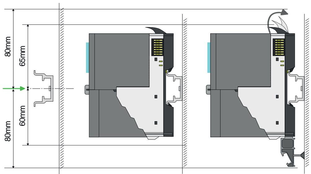
1. Montieren Sie die Tragschiene! Bitte beachten Sie, dass Sie von der Mitte der Tragschiene nach oben einen Montageabstand von mindestens 80mm und nach unten von 60mm bzw. 80mm bei Verwendung von Schirmschienen-Trägern einhalten.
