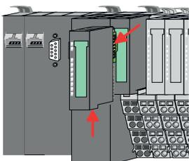
Betätigen Sie die Entriegelung an der Unterseite des rechts neben der CPU befindlichen Elektronik-Moduls und ziehen Sie dieses nach vorne ab.
