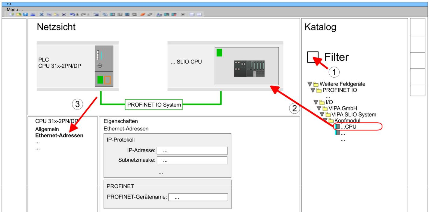
5. ➤ Wählen Sie in der *Netzwerkansicht* das IO-Device "... SLIO CPU..." an und wechseln Sie in die *Geräteübersicht*.
