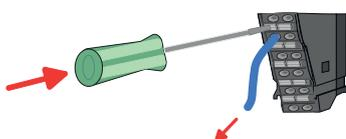
Das Entfernen eines Drahtes erfolgt mittels eines Schraubendrehers mit 2,5mm Klingenbreite.
