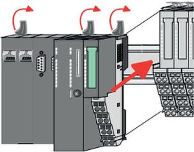
**7.** ➤ Stecken Sie die zu montierende CPU an das linke Modul und schieben Sie die CPU, geführt durch die Führungsleisten, auf die Tragschiene.
