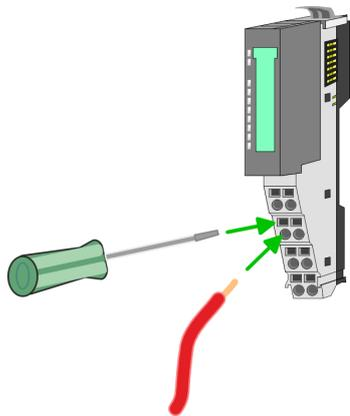
1. Zum Verdrahten stecken Sie, wie in der Abbildung gezeigt, einen passenden Schraubendreher leicht schräg in die rechteckige Öffnung. Zum Öffnen der Kontaktfeder müssen Sie den Schraubendreher in die entgegengesetzte Richtung drücken und halten.
