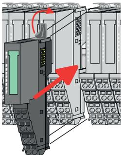
7. ➤ Stecken Sie das zu montierende Modul in die Lücke zwischen die beiden Module und schieben Sie das Modul, geführt durch die Führungsleisten auf beiden Seiten, auf die Tragschiene.
