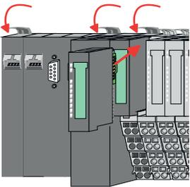
**9.** ➤ Stecken Sie wieder das zuvor entnommene Elektronik-Modul. Für die Montage schieben Sie das Elektronik-Modul in die Führungsschiene, bis dieses an der Unterseite am Terminal-Modul einrastet.
