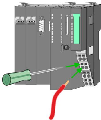
1. Zum Verdrachten stecken Sie, wie in der Abbildung gezeigt, einen passenden Schraubendreher leicht schräg in die rechteckige Entriegelung. Zum Öffnen der Kontaktfeder müssen Sie den Schraubendreher in die entgegengesetzte Richtung drücken und halten.
