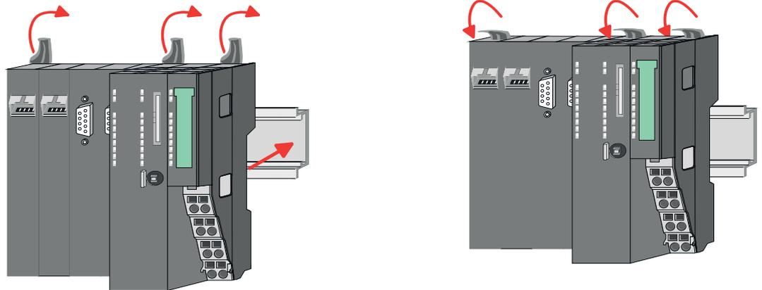
2. Klappen Sie die Verriegelungshebel der CPU nach oben, stecken Sie die CPU auf die Tragschiene und klappen Sie die Verriegelungshebel wieder nach unten.
