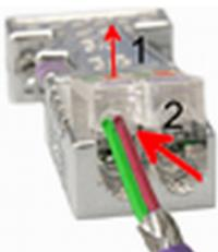
1. ➤ Lösen Sie die Schraube.
