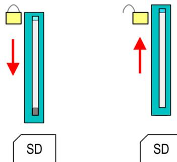
Zum Entnehmen schieben Sie die Schiebemechanik wieder nach oben und drücken Sie die VSD gegen den Federdruck nach innen, bis diese mit einem Klick entriegelt wird.
