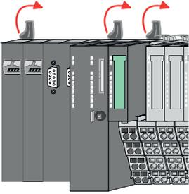
**4.** ➤ Klappen Sie alle Verriegelungshebel der zu tauschenden CPU nach oben.
