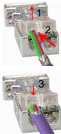
1. ➤ Lösen Sie die Schraube.
