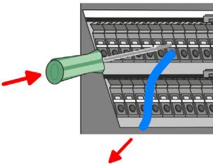
Das Entfernen eines Drahtes erfolgt mittels eines Schraubendrehers mit 2,5mm Klingebreite.
