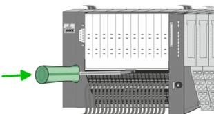
Mittels eines Schraubendrehers haben Sie die Möglichkeit z.B. für einem Modultausch bei stehender Verdrahtung die Steckverbinder zu entfernen. Hierzu besitzt jeder Steckverbinder mittig an der Oberseite einen Entriegelungshebel. Die Entriegelung erfolgt nach folgender Vorgehensweise:
