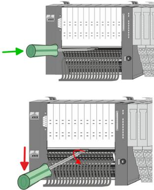
Mittels eines Schraubendrehers haben Sie die Möglichkeit z.B. für einen Modultausch bei stehender Verdrahtung die Steckverbinder zu entfernen. Hierzu besitzt jeder Steckverbinder mittig an der Oberseite einen Entriegelungshebel. Die Entriegelung erfolgt nach folgender Vorgehensweise:
