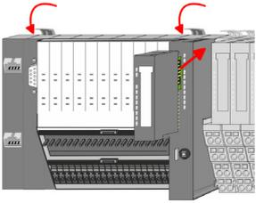
7. → Stecken Sie wieder das zuvor entnommene Elektronik-Modul. Für die Montage schieben Sie das Elektronik-Modul in die Führungsschiene, bis dieses an der Unterseite am Terminal-Modul einrastet.
