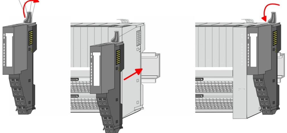
2. ➤ Montieren Sie die gewünschten Peripherie-Module.
