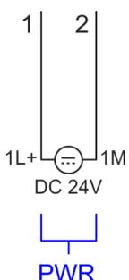
Die CPU besitzt ein eingebautes Netzteil. Das Netzteil ist mit DC 24V zu versorgen. Mit der Versorgungsspannung werden neben der CPU-Elektronik auch die Elektronik des integrierten IO-Teils und der Sensor-Ausgang versorgt. Das Netzteil ist gegen Verpolung und Überstrom geschützt.
