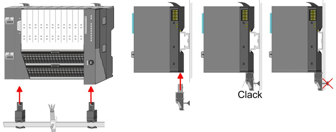
3. Legen Sie ihre Kabel mit dem entsprechend abisolierten Kabelschirm auf und verbinden Sie diese über die Schirmanschlussklemme mit der Schirmschiene.
