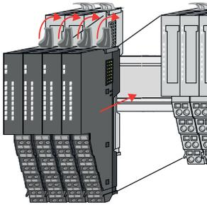
6. ➔ Stecken Sie die zu montierende Modulgruppe in die Lücke zwischen die beiden Module und schieben Sie die Modulgruppe, geführt durch die Führungsleisten auf beiden Seiten, auf die Profilschiene.
