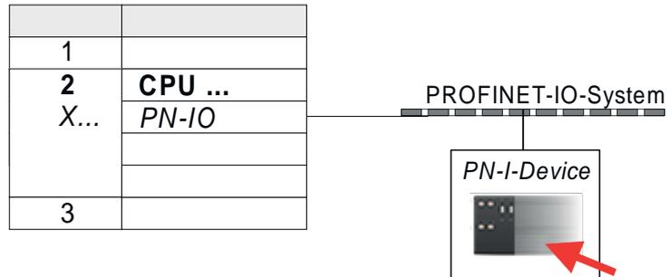
4. Legen Sie für jeden Ausgangsbereich des I-Device im IO-Controller einen Eingangsbereich gleicher Größe an und umgekehrt. Auch hierbei dürfen sich keine Lücken in der Steckplatzbelegung ergeben. Achten Sie insbesondere darauf, dass die Reihenfolge der Transferbereiche zu denen der I-Device-Projektierung passt. Die folgenden Transferbereiche stehen zur Verfügung:
