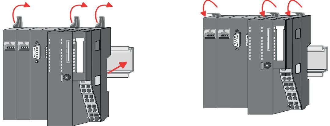
2. → Klappen Sie die Verriegelungshebel der CPU nach oben, stecken Sie die CPU auf die Profilschiene und klappen Sie die Verriegelungshebel wieder nach unten.
