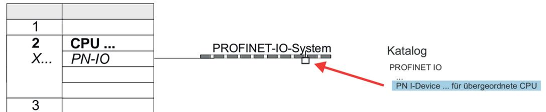
3. Öffnen Sie den Eigenschaften-Dialog, indem Sie auf "PN-I-Device" doppelklicken und tragen Sie unter "Gerätename" den zuvor notierten Namen des System SLIO I-Device ein.
