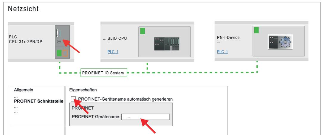
5. → Klicken Sie in der *Netzansicht* auf das PN I-Device und wechseln Sie in die *Geräteübersicht*.
