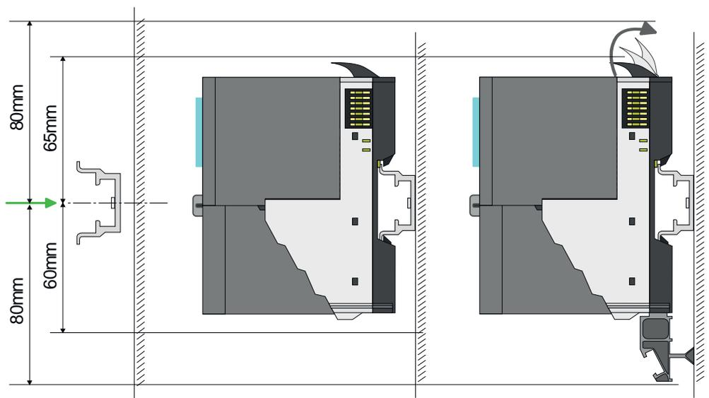
1. Montieren Sie die Profilschiene! Bitte beachten Sie, dass Sie von der Mitte der Profilschiene nach oben einen Montageabstand von mindestens 80mm und nach unten von 60mm bzw. 80mm bei Verwendung von Schirmschienen-Trägern einhalten.
