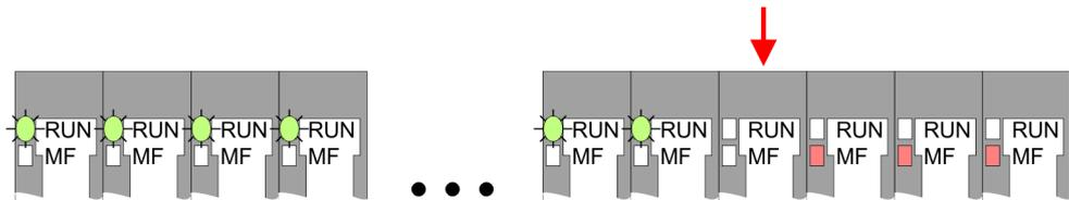
**Verhalten:** Nach dem Einschalten blinken alle RUN-LEDs bis zum fehlerhaften Modul. Bei allen nachfolgenden Modulen leuchtet die MF LED und die RUN-LED ist aus.
