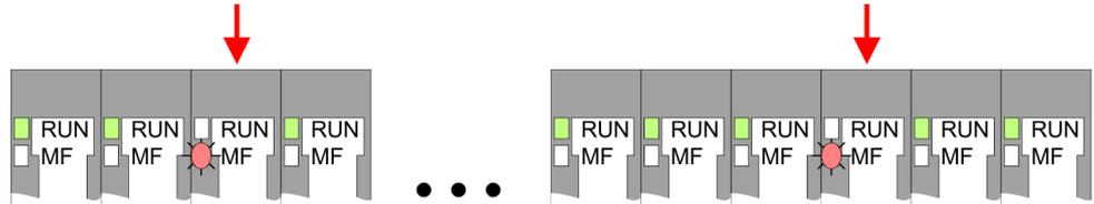
**Verhalten:** Nach dem Einschalten blinkt an einem Modul bzw. an mehreren Modulen die MF-LED. Die RUN-LED bleibt ausgeschaltet.
