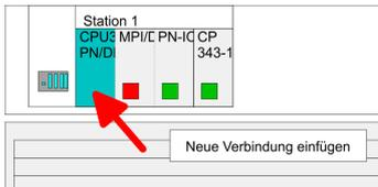
1. ➔ Zur Projektierung von Verbindungen blenden Sie die Verbindungsliste ein, indem Sie die entsprechende CPU anwählen. Rufen Sie über das Kontext-Menü *Neue Verbindung einfügen* auf:
