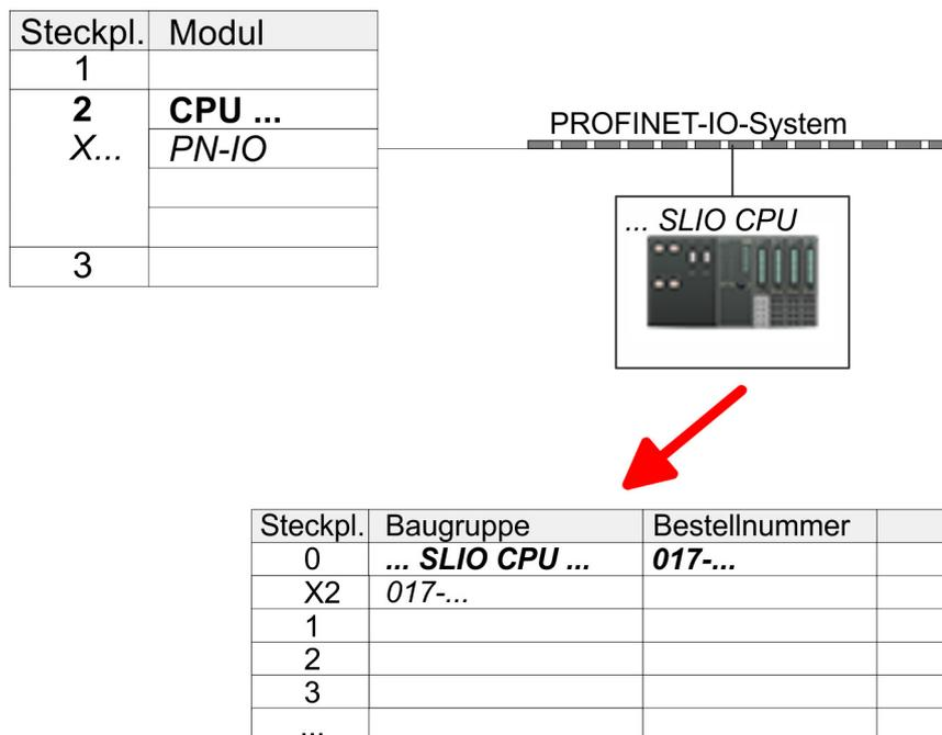
9. Navigieren Sie im Hardware-Katalog in das Verzeichnis "*PROFINET IO → Weitere Feldgeräte → I/O → ... SLIO System*" und binden Sie das IO Device "*017-CEFPR00 CPU*" an Ihr PROFINET-System an.
