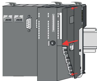
1. → Entfernen Sie vor der Montage der Peripherie-Module die Bus-Blende auf der rechten Seite der CPU, indem Sie diese nach vorn abziehen. Bewahren Sie die Blende für spätere Montage auf.
