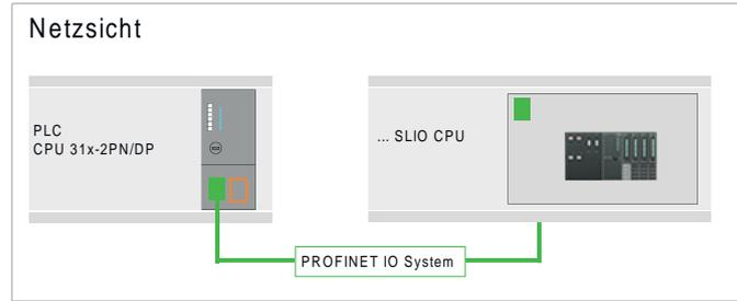
1. Nach der Installation der GSDML finden Sie das "PN I-Device für ... CPU" im Hardware-Katalog unter "Weitere Feldgeräte → PROFINET IO → I/O → VIPA ... → ... SLIO System → SLIO I-Device". Ziehen Sie "PN I-Device für ... CPU" aus dem Hardware-Katalog in die Netzansicht.
