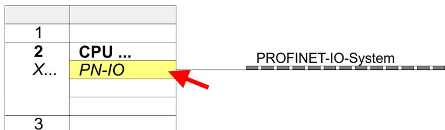
Mit PN-IO parametrieren Sie die PROFINET-Schnittstelle des PROFINET-IO-Controllers und mit Port 1 den Port. Nachfolgend sind die Parameter für PN-IO und Port 1 beschrieben.
