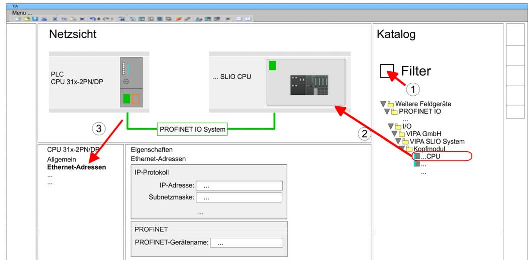
5. → Wählen Sie in der *Netzansicht* das IO-Device "... SLIO CPU..." an und wechseln Sie in die *Geräteübersicht*.
