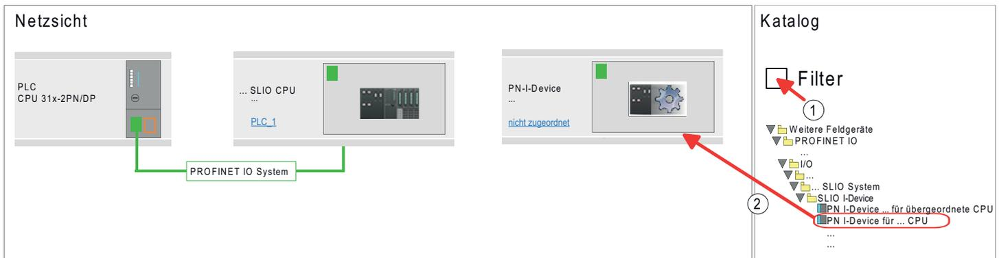
2. Zur Anbindung an die CPU klicken Sie auf "nicht zugeordnet" und wählen Sie die PROFINET-Schnittstelle der CPU aus.
