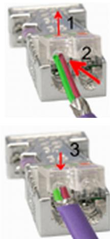
1. Lösen Sie die Schraube.
