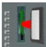
3. ➔ Stecken Sie die Speicherkarte mit der Firmware-Datei in die CPU. Achten Sie hierbei auf die Steckrichtung der Speicherkarte.
