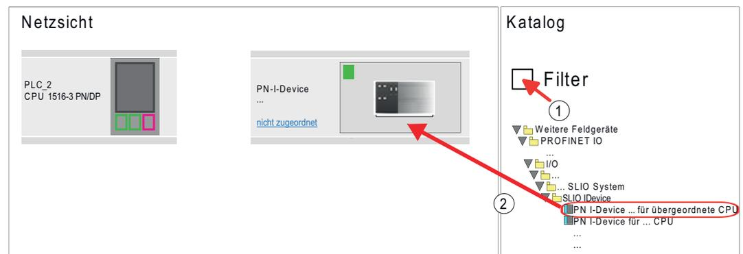
3. Zur Anbindung an die CPU klicken Sie auf "nicht zugeordnet" und wählen Sie die PROFINET-Schnittstelle der CPU aus.
