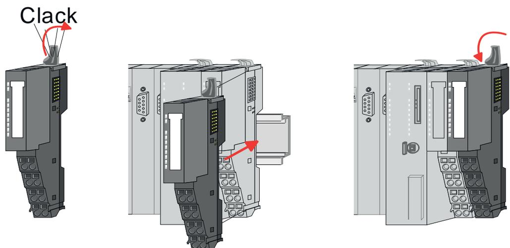
2. → Montieren Sie die gewünschten Peripherie-Module.
