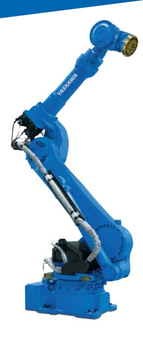
Der flexible 6-Achsroboter MOTOMAN GP225 bietet Höchstleistungen für eine Vielzahl von Applikationen, wie Handling, Maschinenbeschickung und Pressenverkettung.
