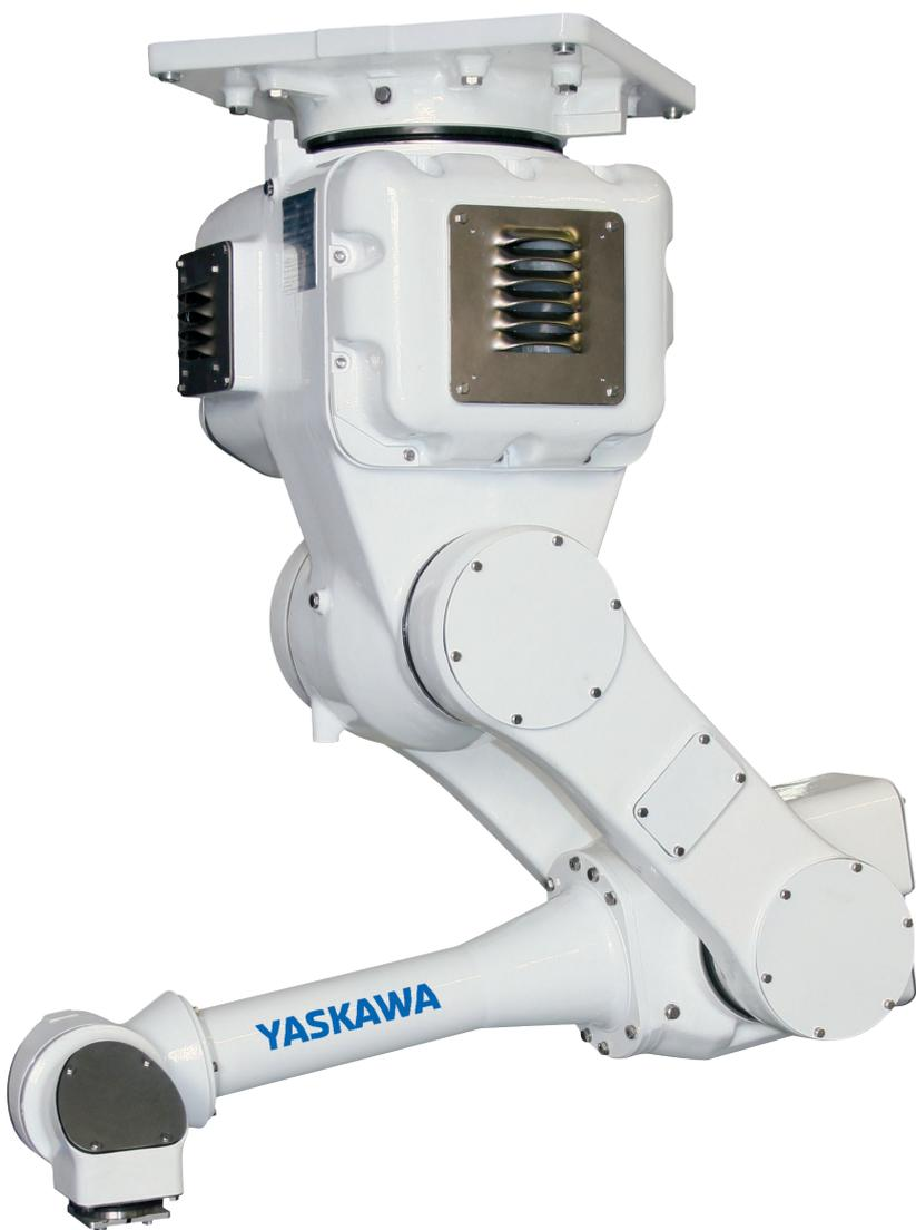
Der MOTOMAN MPK2F-5 ist ein Hochgeschwindigkeits-5-Achs-Roboter, der besonders in den Bereichen Kommissionierung, High-Speed Handling und Picking-Packing sowie anderen Handhabungsanwendungen zur Anwendung kommt.
