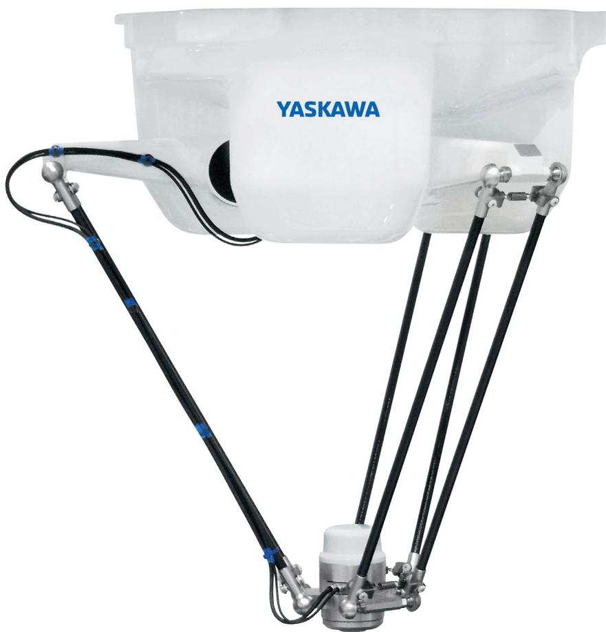
Der kompakte 4-achsige Hochgeschwindigkeitsroboter MOTOMAN MPP3S mit Parallelkinematik verbindet die Schnelligkeit der Delta-Bauform mit einer hohen Traglast und einem großen Arbeitsbereich. Aufgrund des hohen Drehmoments der vierten Achse, der sogenannten Handachse, bewegt der MOTOMAN MPP3S Traglasten bis zu 3 kg mit einer bisher unerreichten Schnelligkeit. Er kann in einer Vielzahl von Bereichen eingesetzt werden, wie z.B. in der Lebensmittel-, Pharma- und Automobilindustrie.
